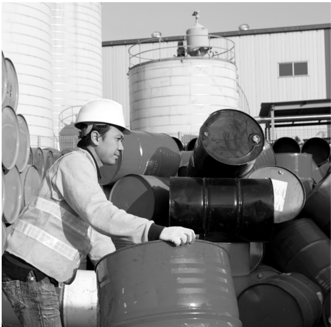
Les fûts de produits chimiques sont empilés de manière désordonnée et inégale, ce qui présente un risque sérieux d'effondrement, de déversement ou de blessure. Certains conteneurs semblent instables et il n'y a pas de confinement secondaire visible ni de signalisation indiquant la nature des substances. Cela présente des risques de fuites, d'exposition aux produits chimiques et de blessures physiques causées par la chute des fûts.
