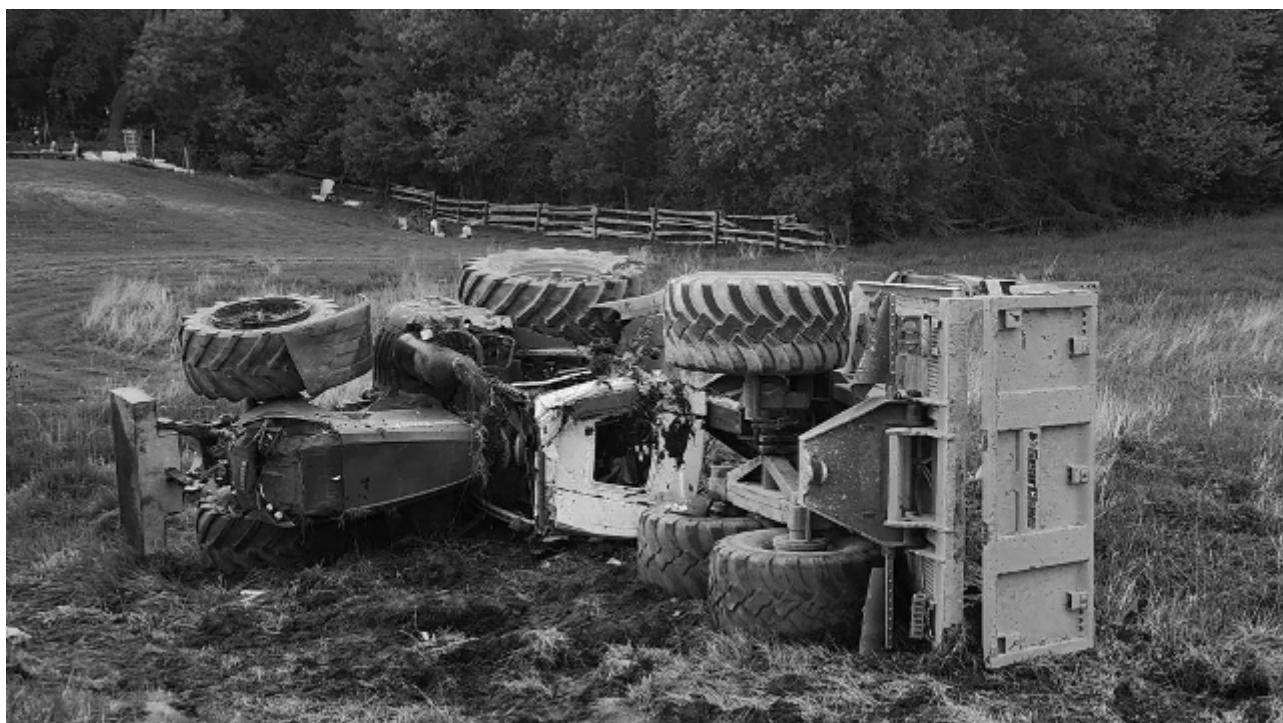
Le tracteur renversé et l'outil attelé suggèrent des pratiques de remorquage ou d'attelage dangereuses, impliquant probablement une configuration ou un point d'attache inapproprié de la chaîne de remorquage. Lorsque les chaînes sont fixées trop haut ou à des pièces instables, le risque de renversement augmente considérablement, en particulier sur un terrain accidenté ou meuble.
