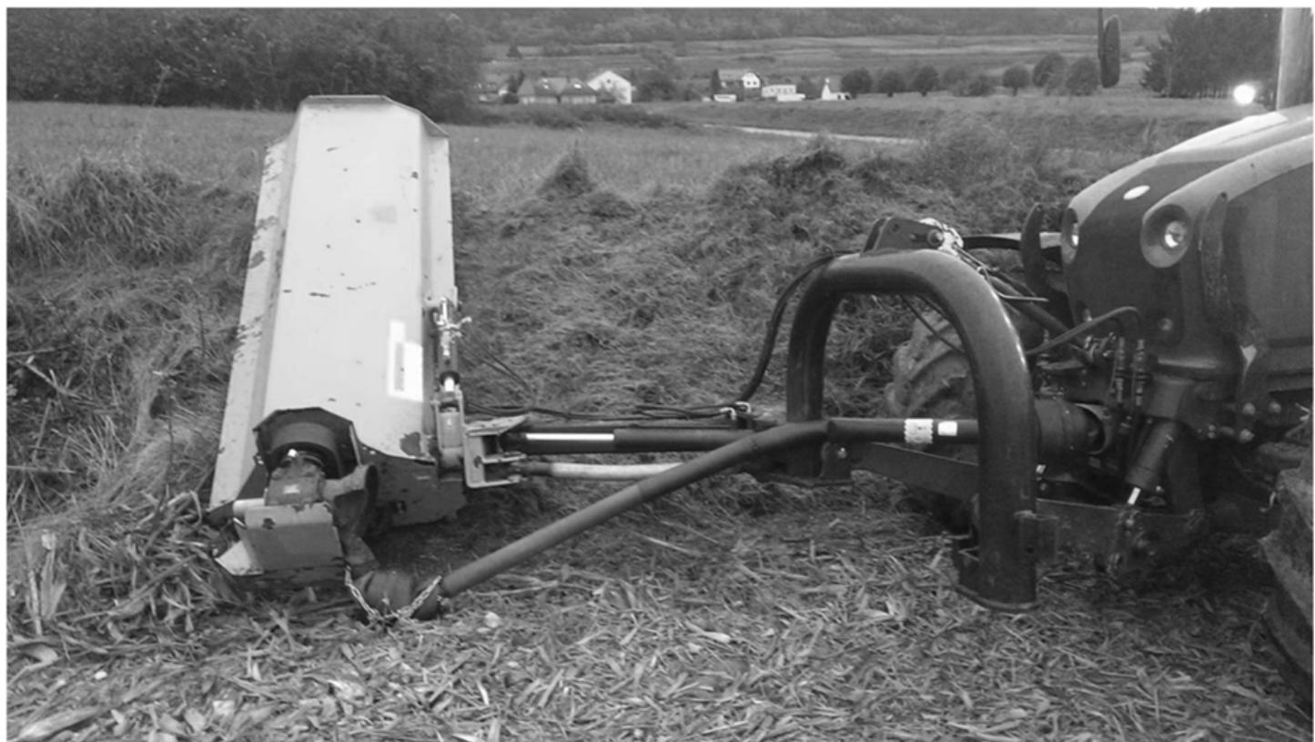
El eje de la toma de fuerza (PTO) está funcionando sin una protección completa, lo que deja los componentes giratorios peligrosamente expuestos. Esto crea un grave peligro de enredamiento para cualquier persona que trabaje cerca de la máquina, especialmente cuando la ropa, las extremidades o los objetos sueltos pueden quedar atrapados rápidamente. La ausencia de protección infringe las prácticas básicas de seguridad para el funcionamiento de equipos agrícolas.
