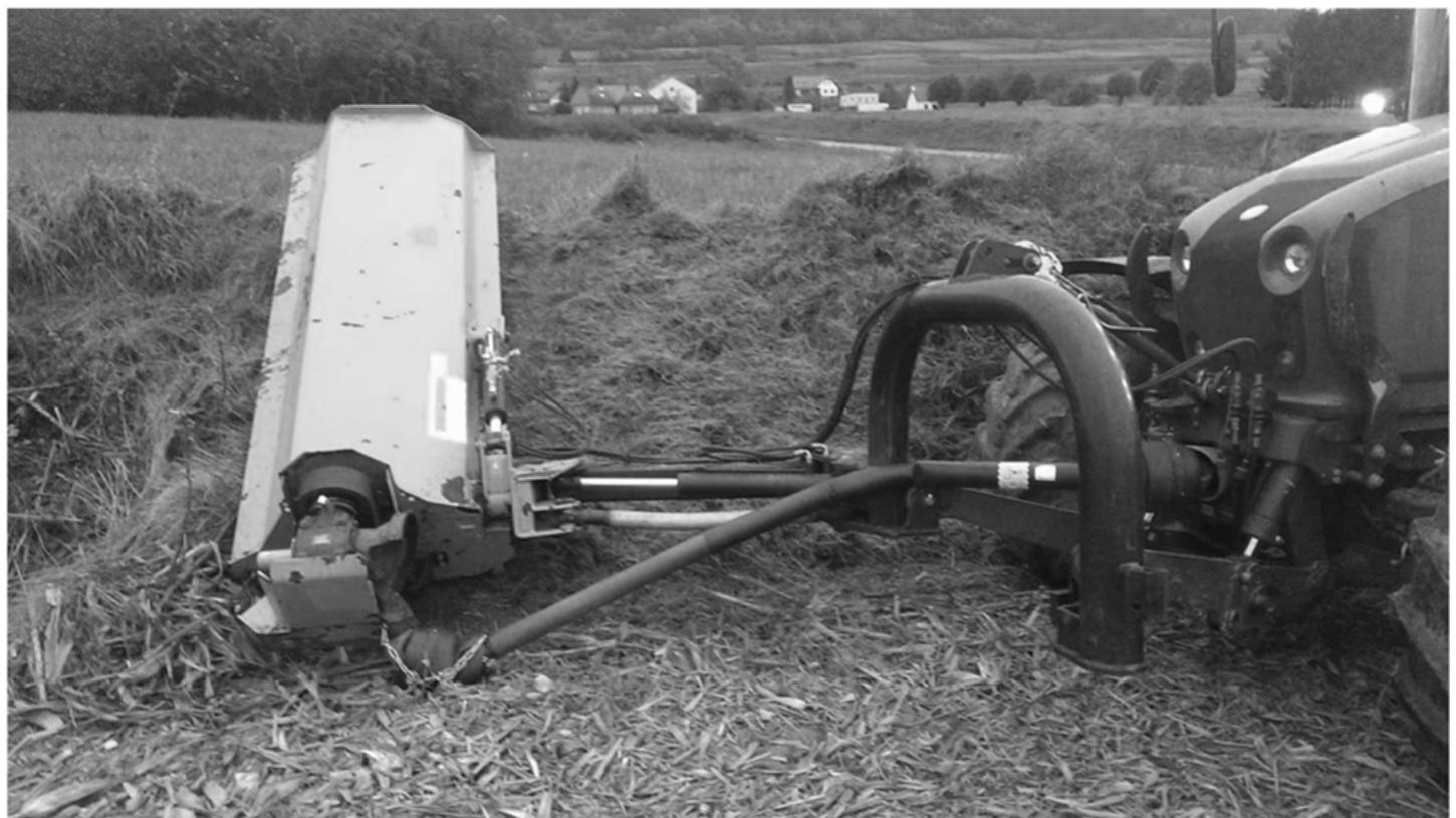
L'arbre de prise de force (PTO) fonctionne sans protection complète, laissant les composants rotatifs dangereusement exposés. Cela crée un risque sérieux d'enchevêtrement pour toute personne travaillant à proximité de la machine, en particulier lorsque des vêtements, des membres ou des objets lâches peuvent être rapidement happés. L'absence de protection enfreint les pratiques de sécurité de base pour l'utilisation d'équipements agricoles.
