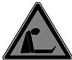
Peligro de asfixia
